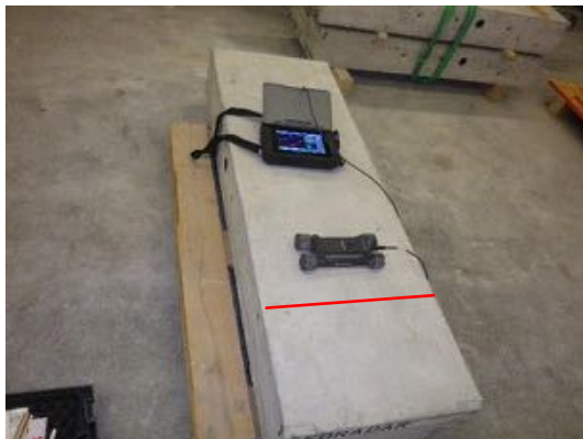
Abbildung 23: Sensorachse parallel zur Stabachse (rote Linie)
