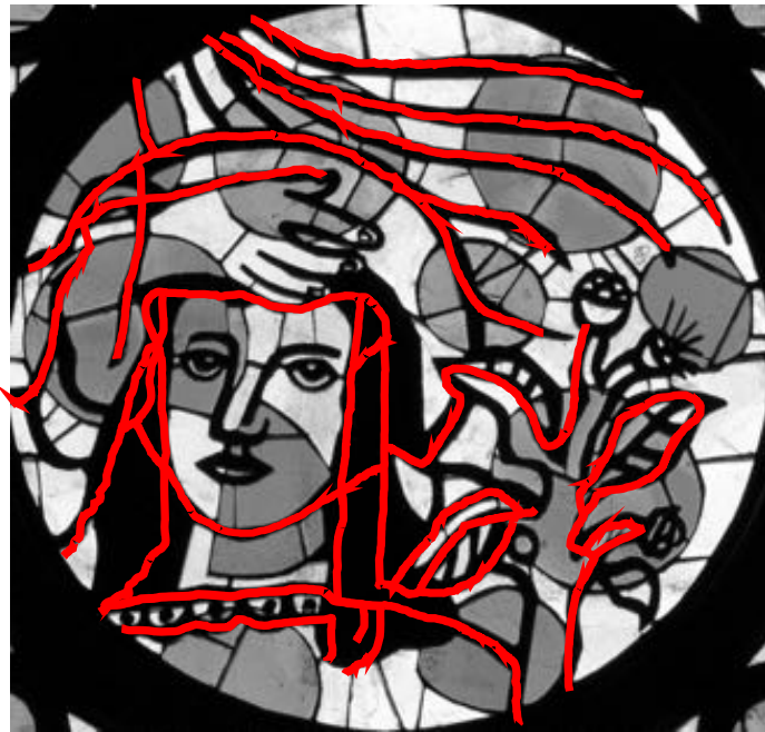
Abbildung 30: Mit dem Magneten ermittelte Bewehrungspositionen auf "L'Annonciation"
