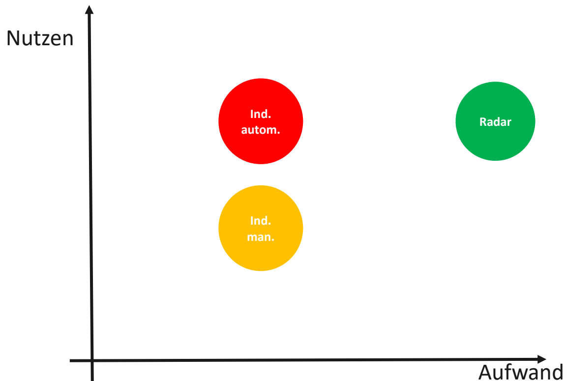
Abbildung 62: Bewehrungsüberdeckung, Induktion mit automatisierter Auswertung (rot), Induktion mit manueller Auswertung (orange), Radar (grün)
