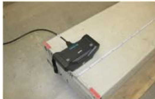
Abbildung 27: Prüfkopf Ultraschall Reflexion im Einsatz auf Betonkörper
