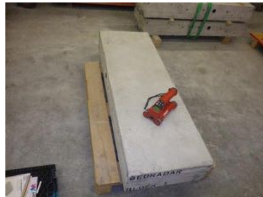
Abbildung 24: Sensorachse im 45 Grad Winkel zur Stabachse
