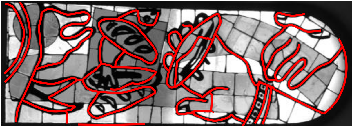
Abbildung 29: Mit dem Magneten ermittelte Bewehrungspositionen (rote Linien) auf "La Multiplication des Pains"
