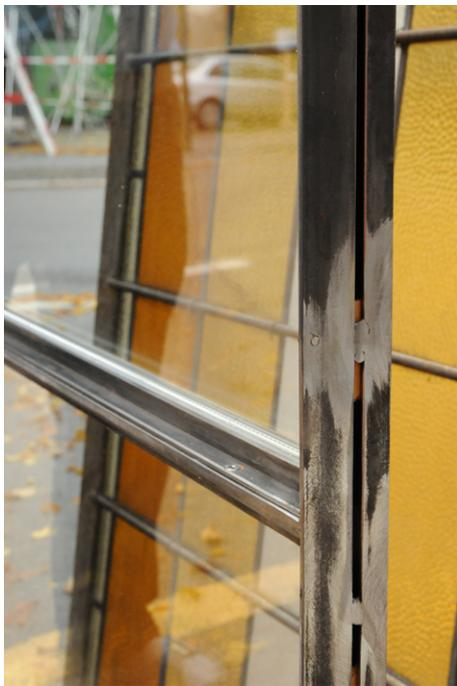
*Abb. 16: In den Laborversuchen verwendete Schutzverglasung mit Isolierglas. Der Rahmen ist durch mehrere Sprossen unterteilt und weist keine vollständige thermische Trennung nach aussen auf.*
