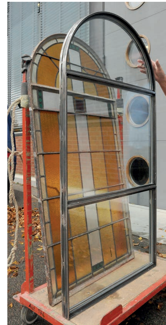
Fenêtre pour les essais en laboratoire : vitrage au plomb et verrière de protection extérieure avec verre isolant dans un cadre métallique subdivisé.
